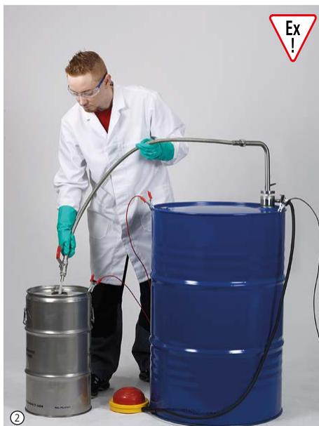
Die Lösemittelpumpe mit Fußbetrieb ist speziell für das Abfüllen von hochreinen Flüssigkeiten wie z.B. Lösungsmitteln geeignet. Alle medienberührten Teile sind aus Edelstahl (1.4301) und PTFE gefertigt. Durch die Fassverschraubung und die beiden Absperrhähne können das Gebinde und die Pumpe hermetisch verschlossen werden.
