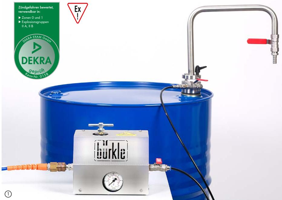
Mit dem Entnahmesystem für Lösemittel lassen sich hochreine Flüssigkeiten schnell und unkompliziert abfüllen. Mittels Druckgas (Druckluft oder Stickstoff) wird ein Überdruck im Gebinde hergestellt, der die Flüssigkeit aus dem Behälter fördert. Die Bedienung über Druckgas bietet den Vorteil, dass der Anwender ohne Mühe auch große Mengen entnehmen kann und dabei beide Hände frei hat, um das Lösemittel abzufüllen.
